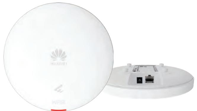
Huawei eKitEngine AP362 é um ponto de acesso interno (AP) Wi-Fi 6 (802.11ax). Ele pode fornecer serviços simultaneamente nas bandas de frequência de 2,4 GHz (2x2 MIMO) e 5 GHz (2x2 MIMO), atingindo uma taxa de dispositivo de até 2,975 Gbps.
